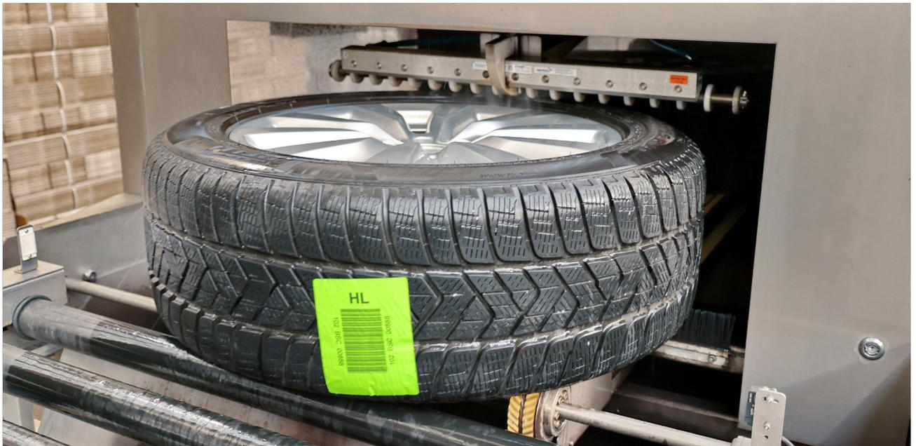
**Leverkusen – DMS Niesen baut seinen Bereich Automotive weiter aus. Um das Full Service-Angebot der Räderlogistik effizienter zu machen, installierte der Leverkusener Logistiker 2022 eine neue Wasch- und Prüfstraße für PKW-Räder. Auf einem elektrisch angetriebenen Rollenband werden die Räder effizient gereinigt und per hochauflöser Kamera fotografiert. Eine KI-basierte Software erfasst Informationen zum Reifenmodell und Typ.**
